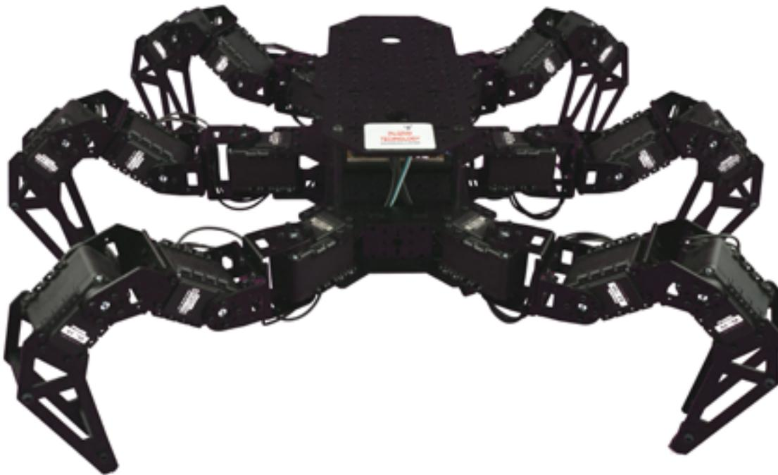
ARIA est un robot agile, capable de se déplacer dans les espaces difficiles d'accès en se fauflant par exemple sous les tuyaux. Le flux vidéo peut être transmis en direct si l'environnement le permet.
